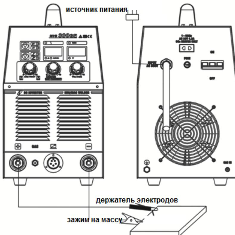
**Заметка: переключите аппарат в режим MMA, чтобы подогреть газовый баллон и предотвратить замерзание ресивера когда аппарата не работает в режиме MIG**
